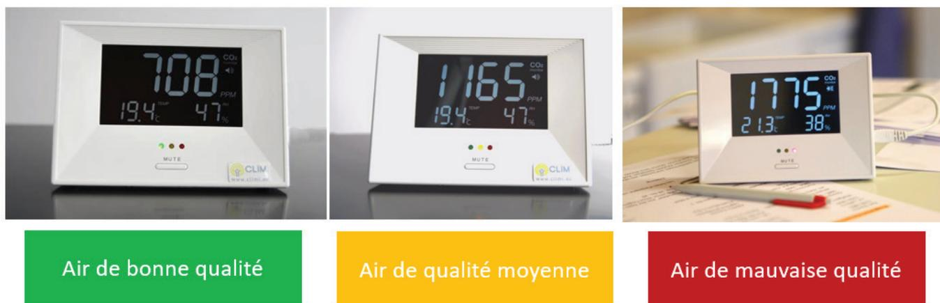
Plus il y a de personnes dans une pièce, plus le taux de CO<sub>2</sub> est élevé. C'est donc un véritable challenge de maintenir un taux de dioxyde de carbone correct dans une classe. Le code du Bien-Être au travail (article III.1-34) prévoit de justifier l'impossibilité d'atteindre l'objectif en dessous de 800 ppm. Les 1200 ppm ne peuvent pas être dépassés.
